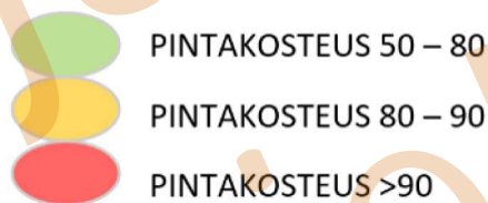
Kuva 109. Pintakosteuskartoituksessa käytettyjen värien suhteelliset kosteustasot.
